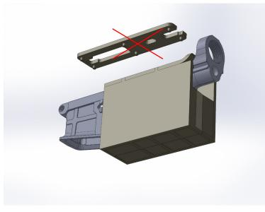
LEAVE THE JIG TOP PLATE OFF FOR THE DRILLING OPERATION.
