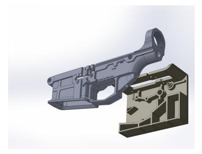
SNAP THE LOWER RECEIVER IN TO THE JIG RIGHT PLATE.
