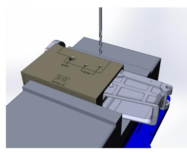
USING THE 5/32" DIA. DRILL BIT, DRILL ALL OF THE WAY THROUGH THE LOWER RECEIVER IN THE LOCATION SHOWN. DRILL DOWN IN STEPS, FREQUENTLY RETRACTING THE BIT TO CLEAR CHIPS AND DEBRIS.
