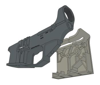
SNAP THE LOWER RECEIVER IN TO THE JIG RIGHT PLATE.
